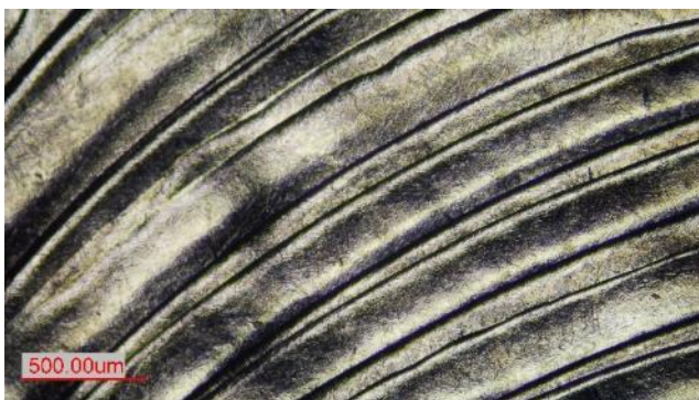
Морфология на повърхността след ЕЛПО при кръгово движение на лъч
