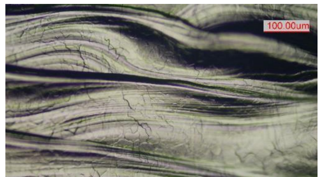
Морфология на повърхността след ЕЛПО при кръгово движение на лъч
